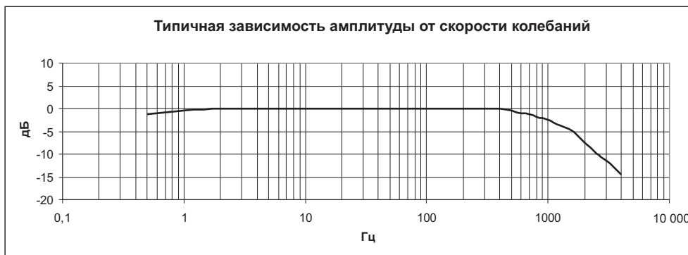
Рис. 1. Частотная характеристика 1 Гц...1000 Гц
