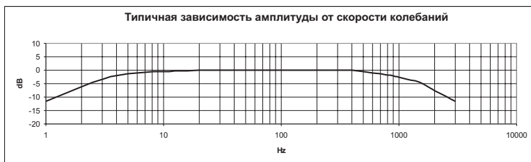
Рис. 1: Частотная характеристика 10 Гц...1000 Гц
