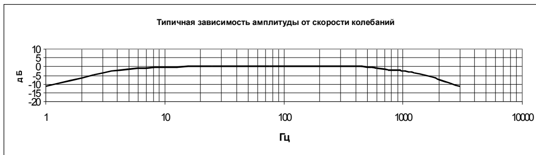
Рис. 1. Частотная характеристика 5 Гц...1000 Гц
