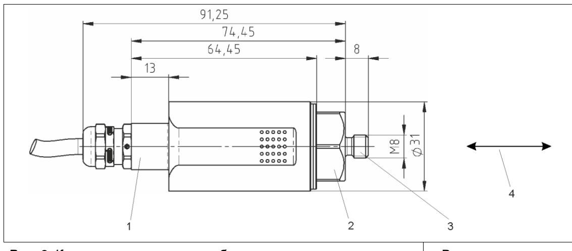
Рис. 9: Корпус со встроенным кабелем
