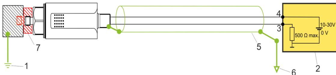
Рис. 11: Альтернативная концепция заземления
